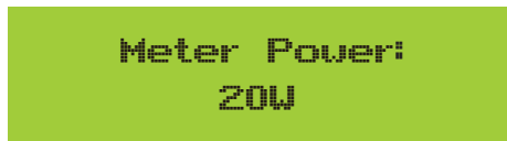
Abb. 7.36 Null-Export-Funktion über Energiezähler einschalten
