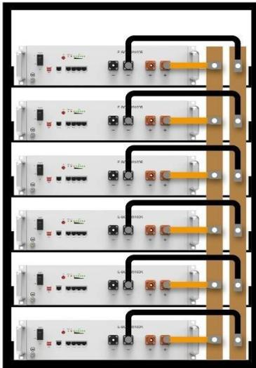
**Hinweis:** Der Akku muss in einem verschlossenen Schrank oder Raum platziert werden. Bei der Installation des Akkus sollte für die Kühlung ein Abstand von 5 cm vorhanden sein. Der Batterieschrank sollte eine Tragfähigkeit von über 100 kg aufweisen
