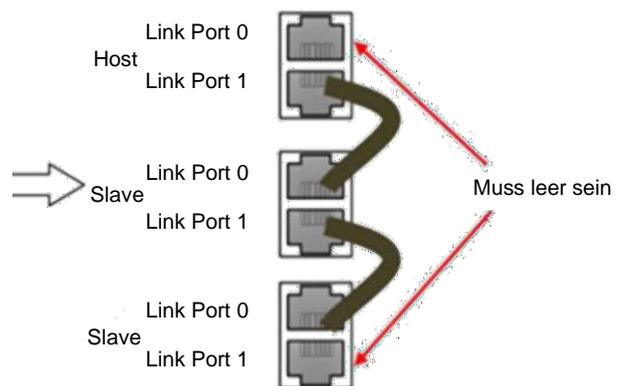
Mehrere Akkus: Host und Slave kommunizieren im Kaskaden-Modus: ein Host, der Rest Slaves. Bitte beziehen Sie sich bei der Kaskadenschaltung auf folgendes Bild. Der Benutzer muss Kommunikationskabel zu den relevanten Link-Ports zwischen den Akkus einfügen und Folgendes beachten:
